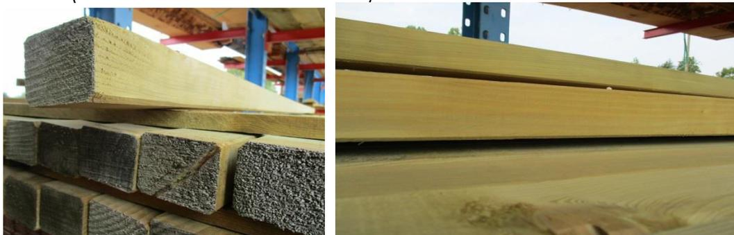
La scierie met également à disposition des bois d'ossature traité autoclave en 45\*120 ou 45\*145 (sur commande possibilité d'avoir d'autre dimension).
