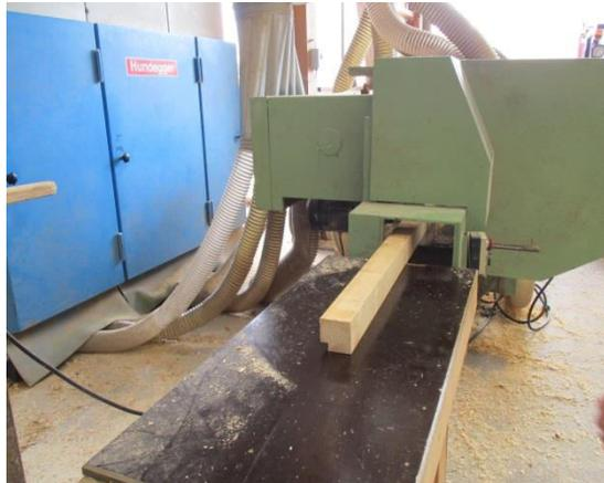
Grâce à cette raboteuse, nous avons la possibilité de réaliser des profils rabotés sur demande.
