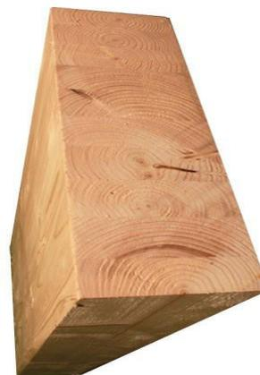
Le **Bois Massif Abouté (BMA)** est obtenu par collage bout à bout de bois purgés de défaut, il permet d'obtenir des bois en grandes longueurs sans pertes et chutes pour les différentes utilisations, souvent utilisés en bois d'ossature ou charpente traditionnelle. Purgé de tout défaut structurel, les BMA permettent d'obtenir une meilleure stabilité dans le temps et une résistance mécanique plus élevée grâce à un collage bout à bout avec entures.
